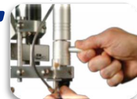
Micromotore a sblocco rapido fresa, per ridurre i tempi di lavoro
